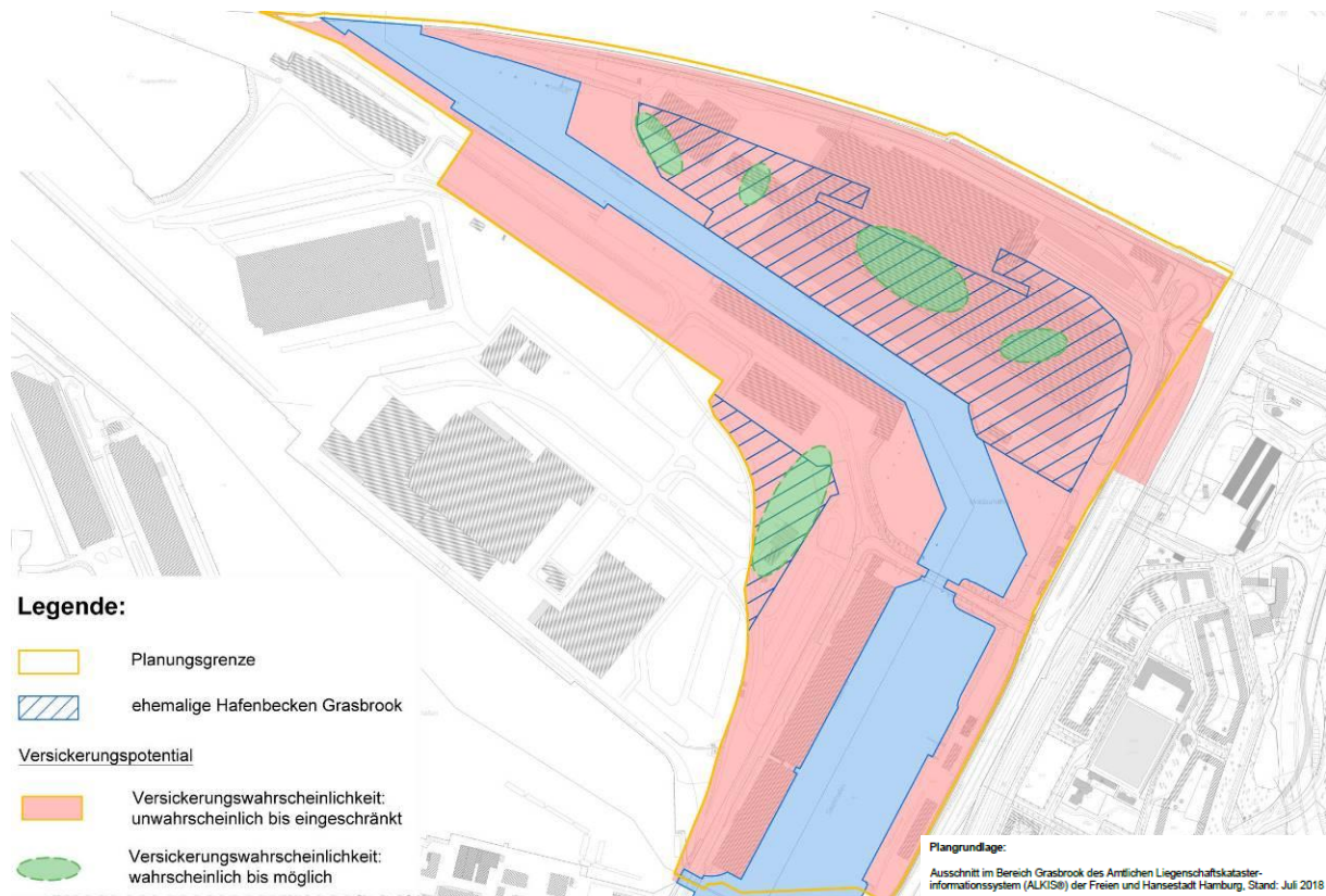
Abb. 96: Flächen möglicher Versickerungsfähigkeit gemäß Orientierender Darstellung der Baugrund- und Grundwasserverhältnisse, Ausschnitt (Quelle: IGB Ingenieurgesellschaft mbH, 06. 12. 2018). Keine exakte Flächendarstellung, übersichtliche Darstellung.
