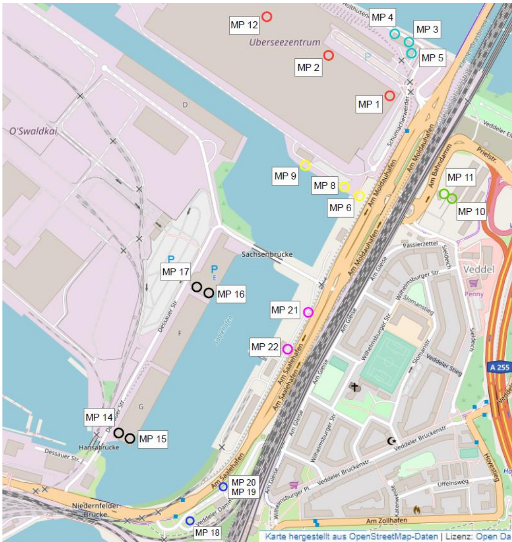
Abb. 107: Messpunkte Schwingungsmessungen, Ausschnitt (Quelle: baudyn GmbH, 05. 12. 2018)
